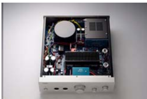
大型の電源トランスを内蔵する
